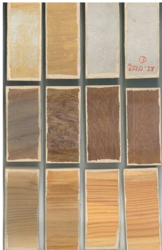
Imagen 21. Muestras aplicadas sobre FIBROCEMENTO, PINO e IROKO tras 336h horas de exposición. De izquierda a derecha: muestra I1, I+A, Al 0,25, Al 0,75.
