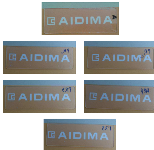
Imagen 2. Muestras procesado aplicadas sobre vidrio. No se observan ni grumos ni falta de transparencia.
