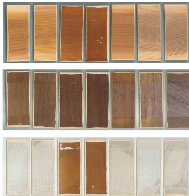
Imagen 20. Muestras 2 ciclos de ensayo, 336 horas. De izquierda a derecha: A, B, C, D, A1_3c, A2_3c, A3_3c, aplicadas sobre PINO, IROKO y FIBROCEMENTO
