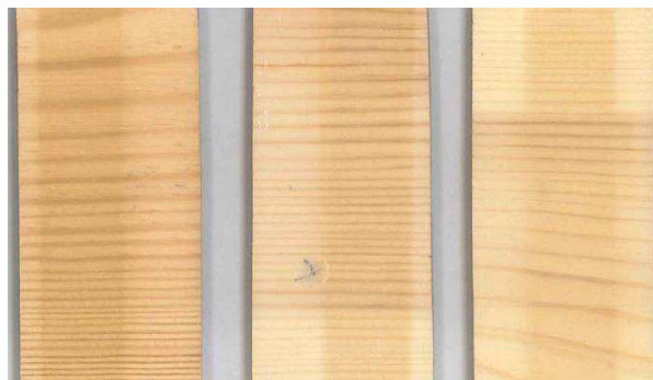
Imagen 22. 500 horas de exposición a la radiación con lámpara de xenon en seco. De izquierda a derecha: muestra A1H, A2H, A3H.
