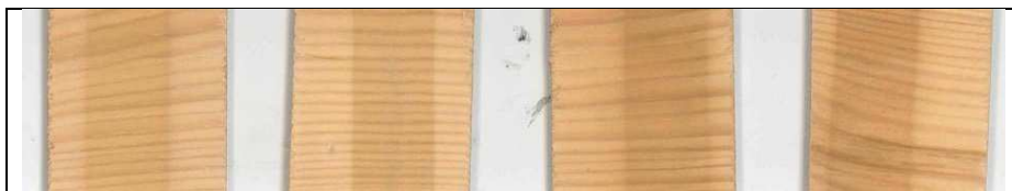
Imagen 16. Muestras aplicadas sobre pino: 100 horas de radiación: A1_16%_PR2 / A1_16%_PR5 / A1_40%_PR2 / A1_40%_PR5
