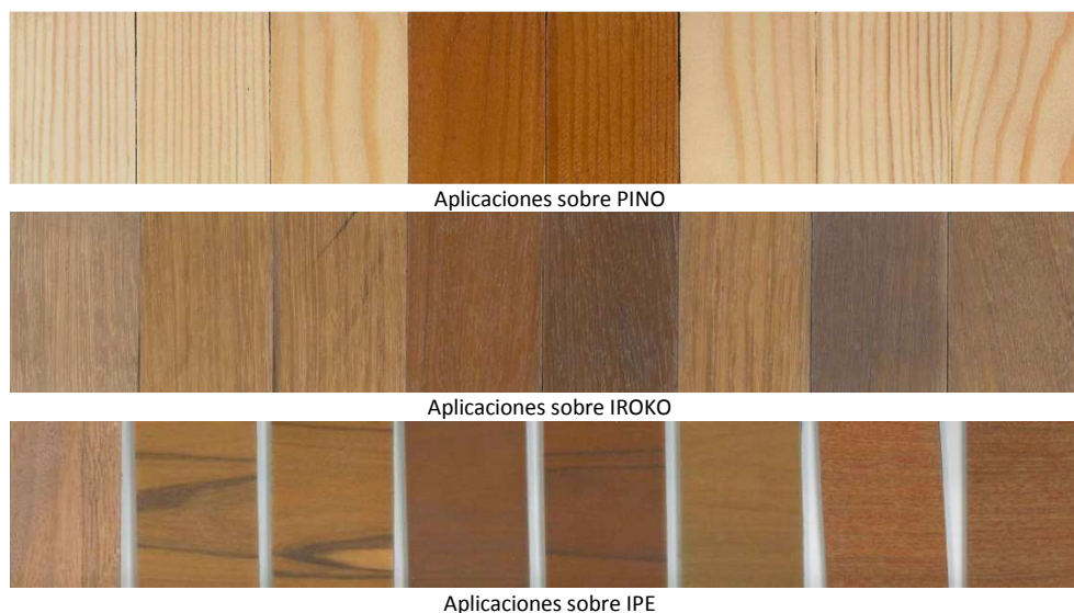
Imagen 7. Muestras de los diferentes sistemas desarrollados aplicados sobre 3 especies de madera diferentes
